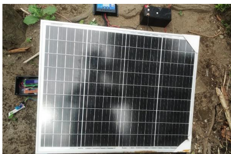
Gambar 3. Rangkaian Panel Surya Keseluruhan dengan Beban
