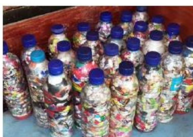
Gambar 4. Tahapan pembuatan ecobrick (Istirokhatun & Nugraha, 2019)
